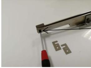
松开螺丝放入需要调节至大小的相应调轨片，固定好螺丝，再调节轨道前后槽宽相同，固定底部螺丝
